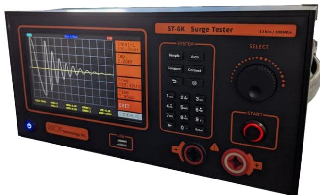
インパルス巻線試験機 STシリーズは、変圧器、モーター、ローター、ステーター、電気バルブ、発電機、およびあらゆる種類のコイルなどの巻線製品をテストするための不可欠な機器です。絶縁不良を検出するための理想的なテスト方法を提供し、高速サンプリング技術を使用して、標準/マスターコイルとDUT(被試験デバイス)の波形を測定器に保存できます。マスターとDUTの波形を比較することで、問題の個所を簡単に見つけることができます。さらに、理想的なコイル試験の革新的機能として部分放電試験、インダクタンス値測定を可能としました。STシリーズは生産および品質管理に特に有効です。
